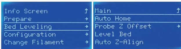
**2** Cliquez sur Nivellement du lit → Remise à zéro automatique (préchauffage uniquement) → Remise à zéro automatique.
