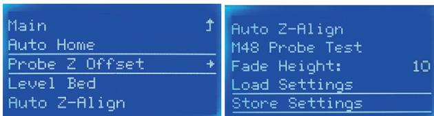
**3** 3. Après l'arrêt de la machine, revenez et cliquez sur « Décalage Z de la sonde » pour régler la distance entre la buse et le lit chaud.
