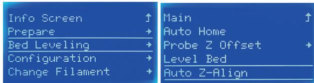
**1** Appuyez sur le bouton > Écran principal → Nivellement du lit → Alignement automatique de l'axe Z
